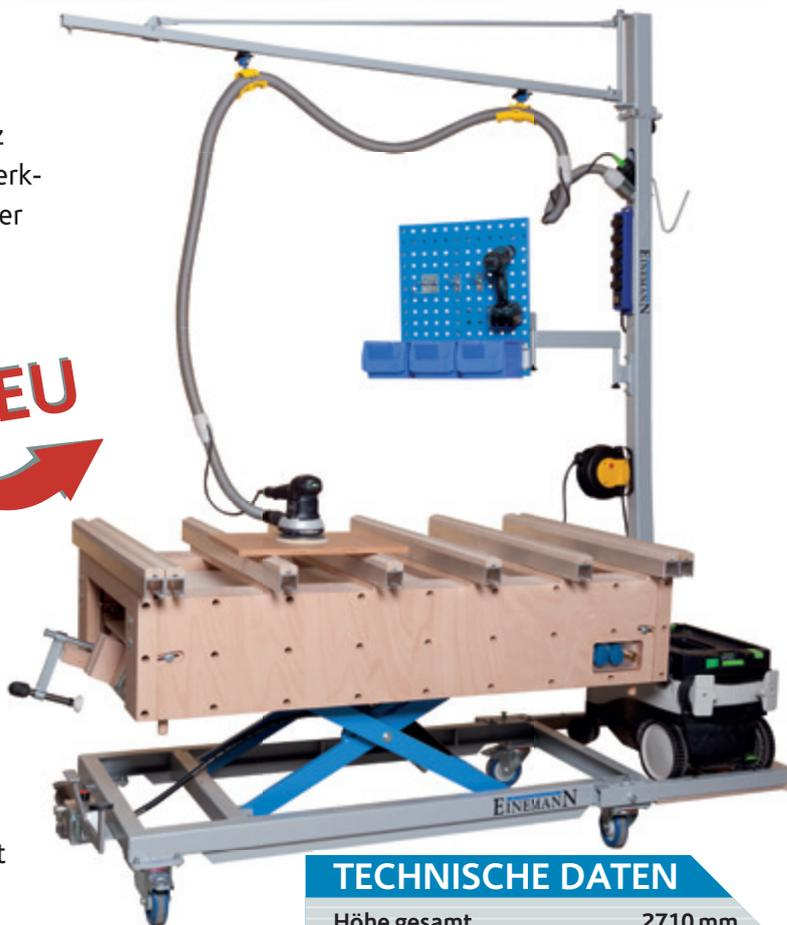
Der Staubsauger ist direkt am Montagetisch auf einer Plattform positioniert und ist somit immer dort, wo er gebraucht wird. Der Schwenkausleger kann natürlich auch bei älteren Montagetischen nachgerüstet werden.
