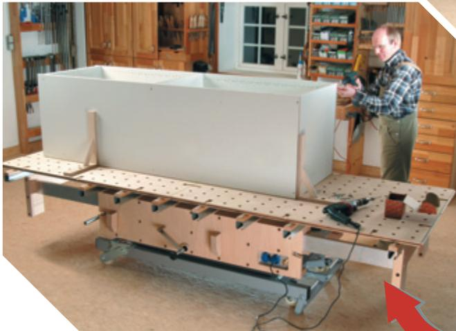
Mit den im Tisch versteauten Rasterplatten lässt sich auf den Querträgern eine platten-förmige Arbeitsfläche auslegen. So ist eine in der Länge und Breite flexible und ebene Arbeitsfläche passend zu den zu bearbei-tenden Werkstücken schnell auslegbar.
